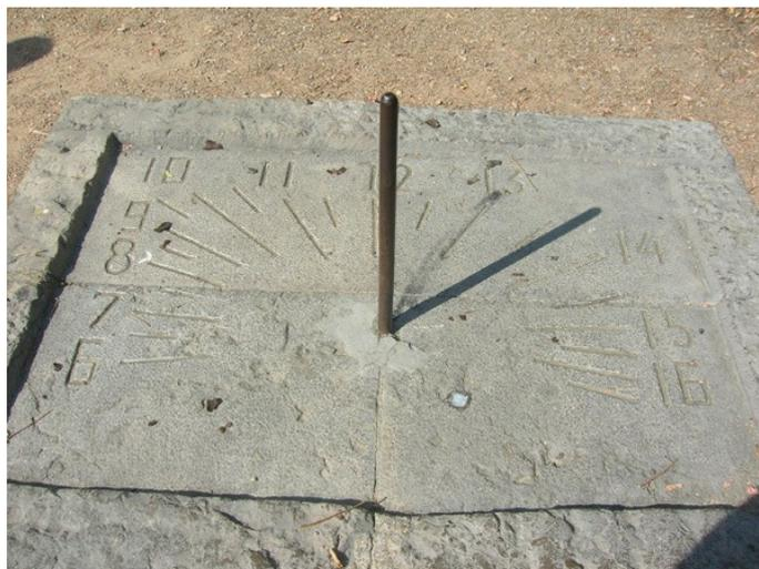
Перемещение стрелки-тени, отражающей суточное вращение Земли, позволяет определять время. Конечно, пользоваться такими часами можно было только в светлое время суток. К тому же в разные сезоны, то есть летом и зимой, продолжительность часа была неодинаковой, что подвигло людей придумывать новые виды часов.
